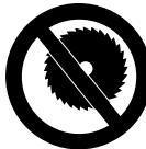
Запрещается применять пильные диски, твердосплавные, спасательные, дереворежущие или иные зубчатые инструменты – **опасность получения смертельной травмы!** В противоположность равномерному съему частиц при эксплуатации абразивно-отрезных дисков, зубья пильного диска с долотообразными зубьями при резке могут застрять в материале. Это способствует агрессивной резке, что может привести к возникновению неконтролируемых, чрезвычайно опасных реактивных сил (обратный удар) агрегата.
